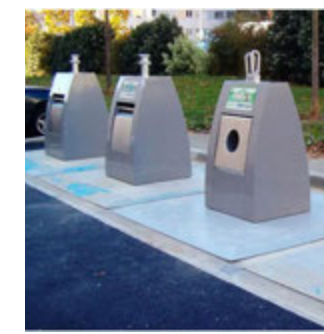
poubelles enterrées ingegraven containers
